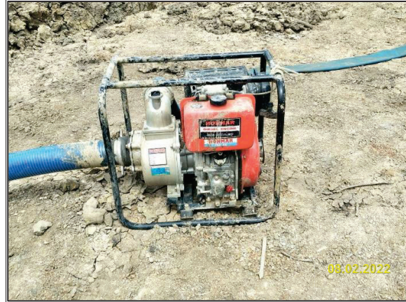
รูปที่ 2-27 เตรียมเครื่องสูบน้ำแรงดันต่ำ สำรองไว้ใช้งานตลอดระยะเวลาการก่อสร้าง
